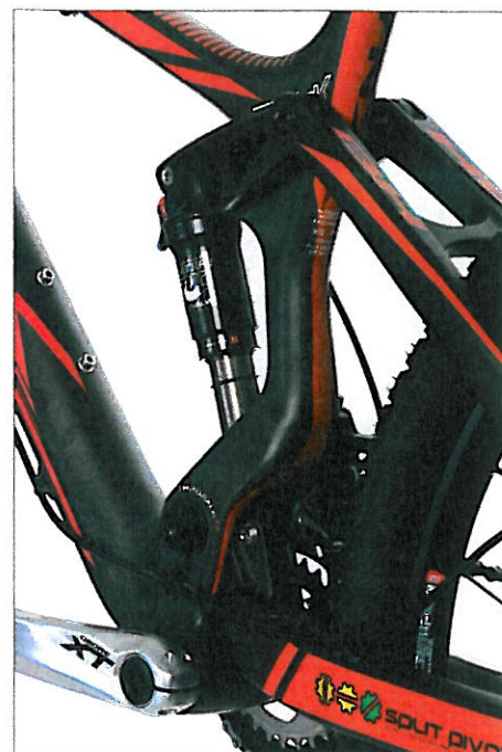
De achterdemper is zwevend gemonteerd en is dus in het verlengde van de liggende achtervork bevestigd. De zitbuis is hierdoor onderbroken, zodat er plaats is voor een onderdeel dat de demper verlengt
