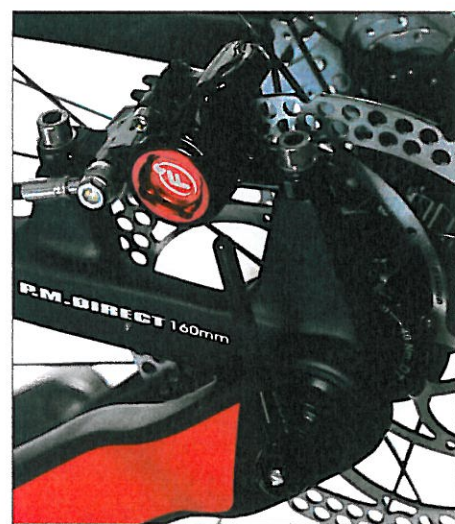
De fameuze Split Pivot, een achteras die dienst doet als spil en die onder meer voorkomt dat de vering bij het remmen blokkeert. Let ook op de Postmount-rempatten en de opmerkelijke afwerking van het frame dat aan de moderne standaarden beantwoordt met een PF92 trapshuis, een Direct Mount voorderrailleur, interne kabelgeleidingen, een conisch balhoofd en een QR15 en X12-as.
