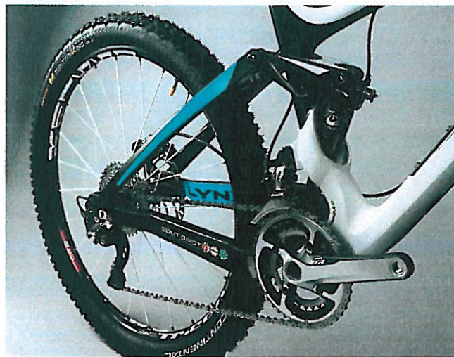
La suspension Fox 2013 a été customisée à la demande de Dave Weagle pour s'adapter à la cinématique particulière du châssis, qui s'articule autour du fameux Split Pivot.
