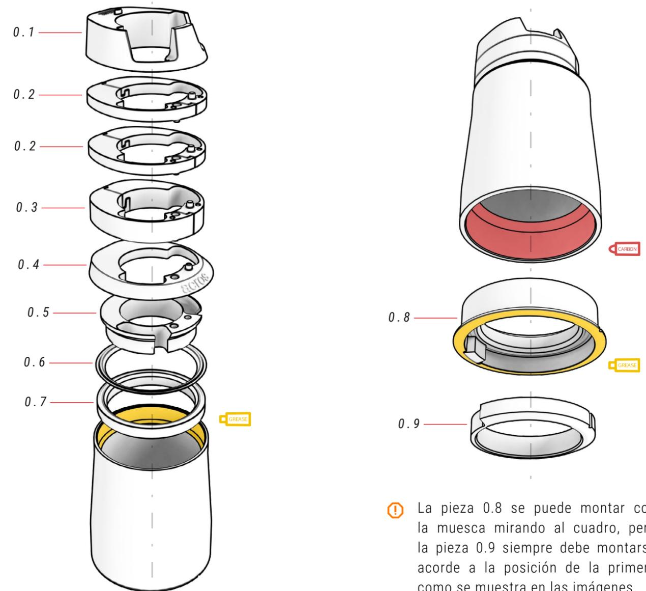
⚠ La pieza 0.8 se puede montar con la muesca mirando al cuadro, pero la pieza 0.9 siempre debe montarse acorde a la posición de la primera como se muestra en las imágenes.
