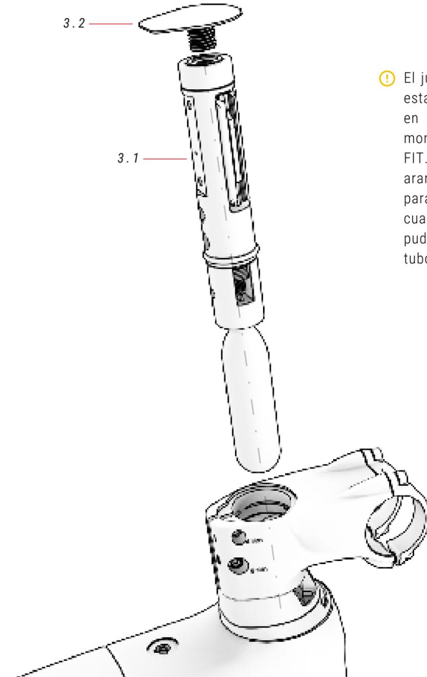
⚠ El juego de dirección debe estar completamente vacío en su interior para poder montar la herramienta FIT. Utiliza el sistema de arandelas FIT diseñado para este fin y retira cualquier obstáculo como pudiera ser la araña en el tubo de dirección.
