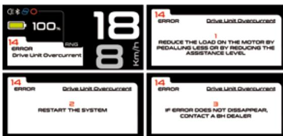
Si le problème persiste, couper le moteur et prendre contact avec un point de vente BH. Les erreurs de fonctionnement éventuelles sont décrites dans le chapitre « Dépannage » de ce manuel.
