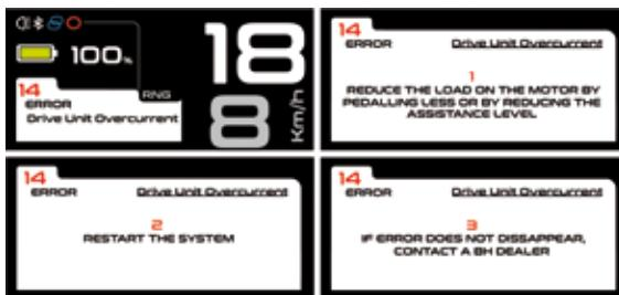
Wenn das Problem bestehen bleibt, schalten Sie den Motor ab und setzen Sie sich mit einem BH-Händler in Verbindung. In dem Abschnitt Problemlösung des vorliegenden Handbuchs werden die möglichen Funktionsstörungen beschrieben.
