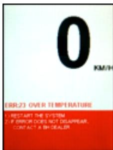
Si el problema persiste, desconecte el motor y contacte con un punto de venta BH. En la sección Resolución de Problemas del presente manual se describen los posibles errores de funcionamiento.
