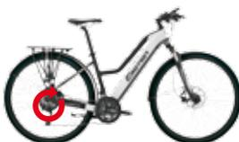
Sistema con motore posteriore
