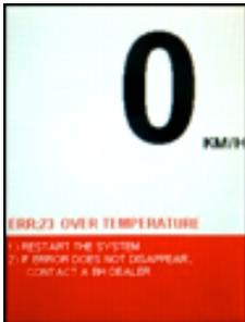
Wenn das Problem weiterbesteht, schalten Sie den Motor ab und setzen Sie sich mit einem BH-Händler in Verbindung. Im Abschnitt Problemlösung dieser Gebrauchsanweisung werden die möglichen Funktionsstörungen beschrieben.
