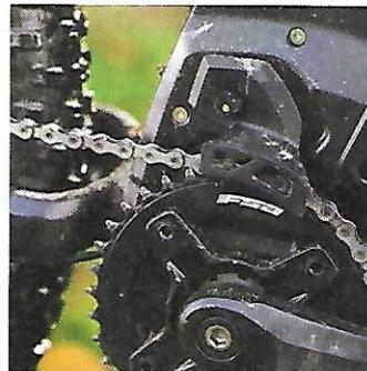
**Links** Der neue und leistungsstärkere Brose Drive S Motor wird im Falle eines Aufsetzers durch eine Skid Plate geschützt. **Mitte** Der große, vollständig integrierte 700 Wattstunden-Akku lässt sich bequem nach oben aus dem Rahmen ziehen. **Rechts** Eine Kettenführung sorgt selbst im ruppigsten Gelände dafür, dass die Kette keinesfalls abspringt.
