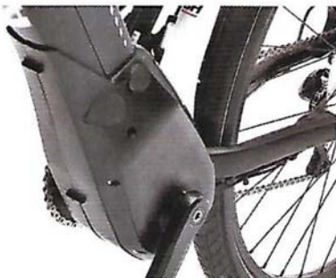
Der Brose Mittelmotor Drive S mit max. 90 Nm und Außenladebuchse.
