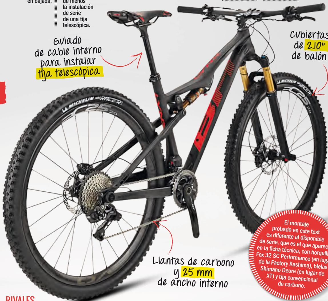
Guiado de cable interno para instalar tija telescópica
