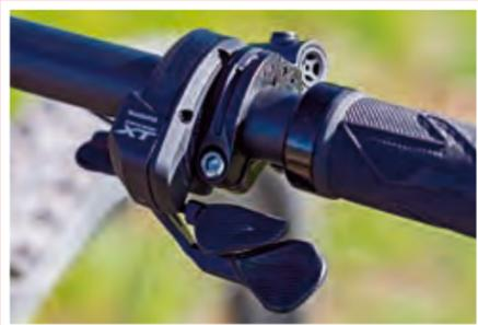
Los pulsadores Firebolt de Shimano se colocan exactamente donde descansa el dedo pulgar, para cambiar más rápida y cómodamente.
