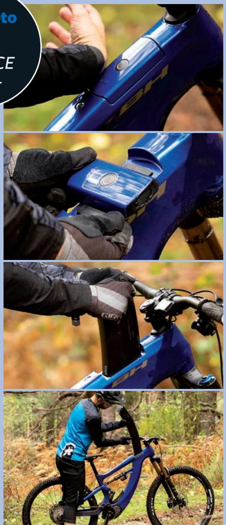
La Xtep Carbon se basa en el mismo concepto que la AtomX en el que el tubo diagonal es el gran protagonista, con la batería de gran autonomía ocupando todo su interior. Para extraer la batería podemos hacerlo por dos vías, o mediante el Smart Key Bracelet (una pulsera) que acciona un pequeño motor que abre la cerradura, o directamente a través de una llave (se suministran dos con la bici).
