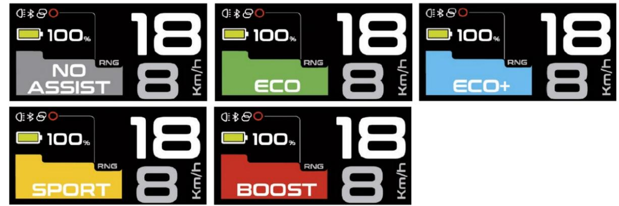
Con objeto de incrementar la vida de la batería y prevenir a la misma de una descarga completa que pudiera dañarla, los modos de asistencia están limitados en función de la carga de la batería:
