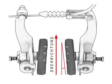
Sowohl die Bremsklötze als auch die Bremsbeläge der Scheibenbremsen sind Verschleißteile, die gemäß den Spezifikationen des Herstellers ausgetauscht werden müssen. Wie die Bremsbeläge erleiden auch die Bremsscheiben einen Verschleiß und müssen vor jeder Fahrt auf Abnutzung, Verformung oder sonstige Anomalien geprüft werden.
