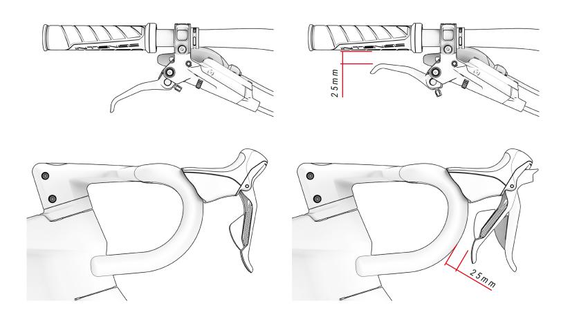
Andererseits muss vor jeder Fahrt in Abhängigkeit des Bremsentyps der Zustand der Kabel oder des Hydrauliksystems überprüft werden. Bremsen mit Kabelfunktion müssen gemäß dem vom Hersteller der Bauteile definierten Anzugsdrehmoment fest angezogen werden. Ferner ist eine Sichtprüfung auf eventuelle Beschädigungen vorzunehmen.
