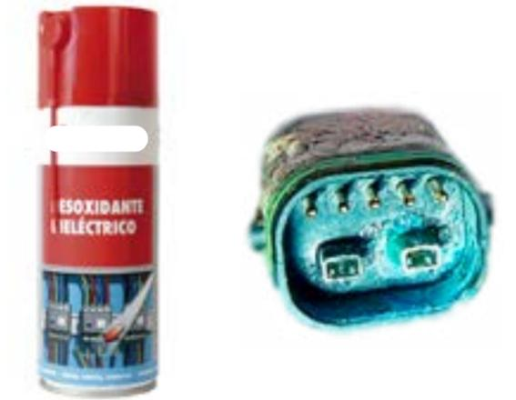
⚠ Wenn ein elektrischer Anschluss feucht wird oder durch eine äußere Verschmutzung verdichtet ist, kommt es zu einer chemischen Reaktion, durch die die Verbindungen sulfatisiert werden. Das heißt, das Kupfer der Kontakte oxidiert und es kommt zu Störungen bei der Leitfähigkeit.
