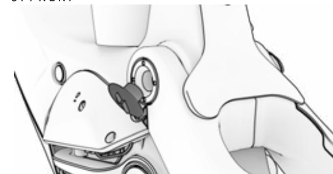
3. SCHLIESSEN SIE IMMER ZUERST DAS LADEGERÄT AN DIE BATTERIE AN UND DANACH AN DEN NETZSTROM.
