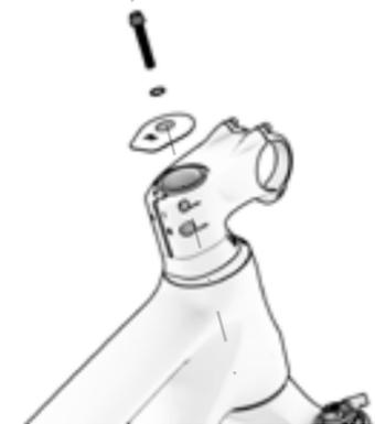
**⚠** Die Unterlegscheiben erfüllen keine Funktion, wenn die Spinne hinzugefügt wird. Sie können sie daher entfernen oder im Inneren des Vorbau aufbewahren.
