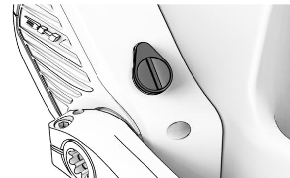
7. DIE XPRO-BATTERIE WIRD GELADEN, WENN SIE SICH IM FLASCHENHALTER BEFINDET, DAS FAHRAD GELADEN WIRD UND DAS DISPLAY EINGESCHALTET IST.
