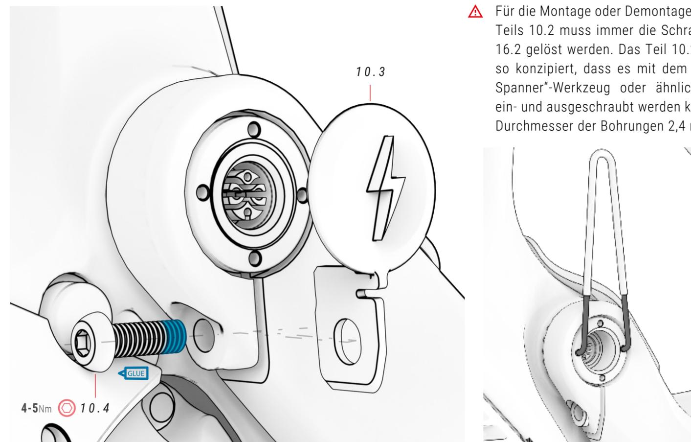
⚠ Für die Montage oder Demontage des Teils 10.2 muss immer die Schraube 16.2 gelöst werden. Das Teil 10.2 ist so konzipiert, dass es mit dem „Pin Spanner“-Werkzeug oder ähnlichem ein- und ausgeschraubt werden kann. Durchmesser der Bohrungen 2,4 mm.
