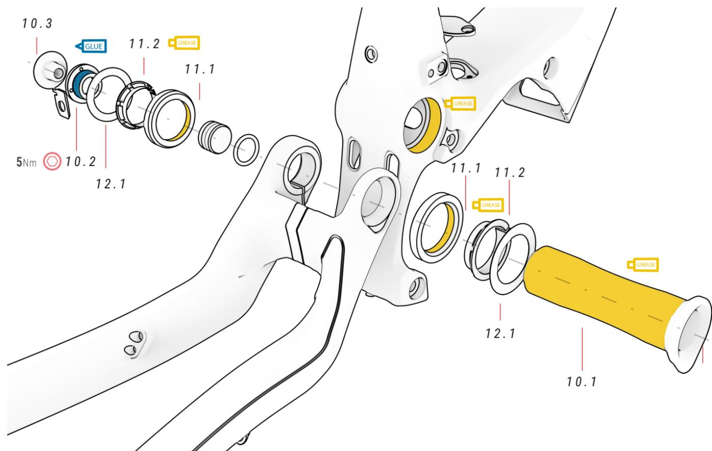
⚠ Das Teil 10.2 darf nicht mit mehr als 5 Nm angezogen werden, da seine Funktion darin liegt, Spiel zu vermeiden. Die Schraube 16.2 befestigt vollständig das Teil 10.2 und den Rest der Schwingenbaugruppe.
