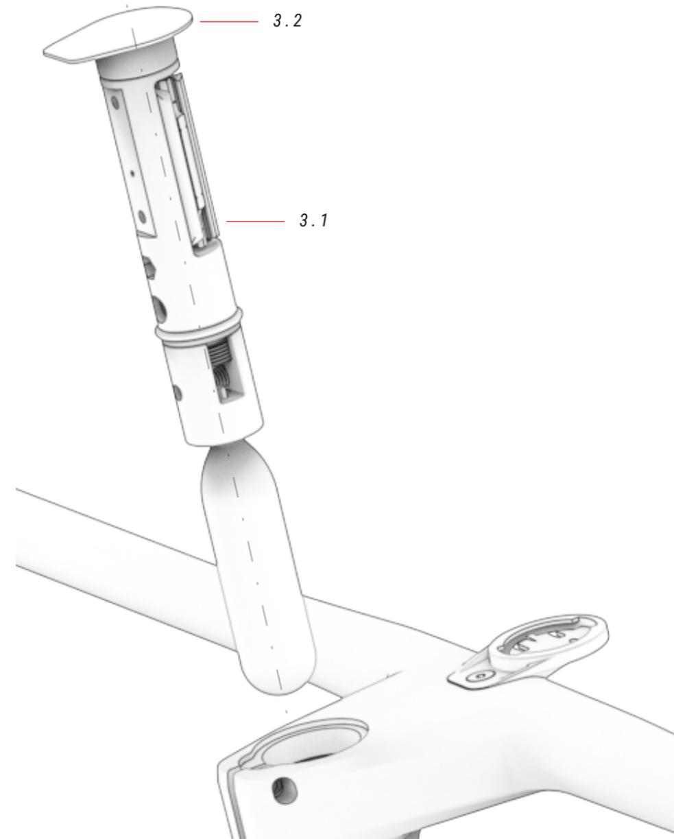
ⓘ Bevor das FIT-Tool montiert werden kann, muss der Steuersatz innen komplett leer sein. Nutze hierfür das dafür vorgesehene FIT-Unterlegscheibensystem und entferne etwaige Hindernisse wie z.B. die Spider am Steuerrohr.
