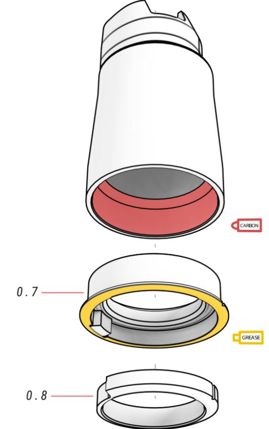
⚠ Das Teil 0.7 kann mit der zum Rahmen zeigenden Kerbe montiert werden, aber das Teil 0.8 muss immer im Verhältnis zur Position der ersten montiert werden, wie in den Abbildungen dargestellt.
