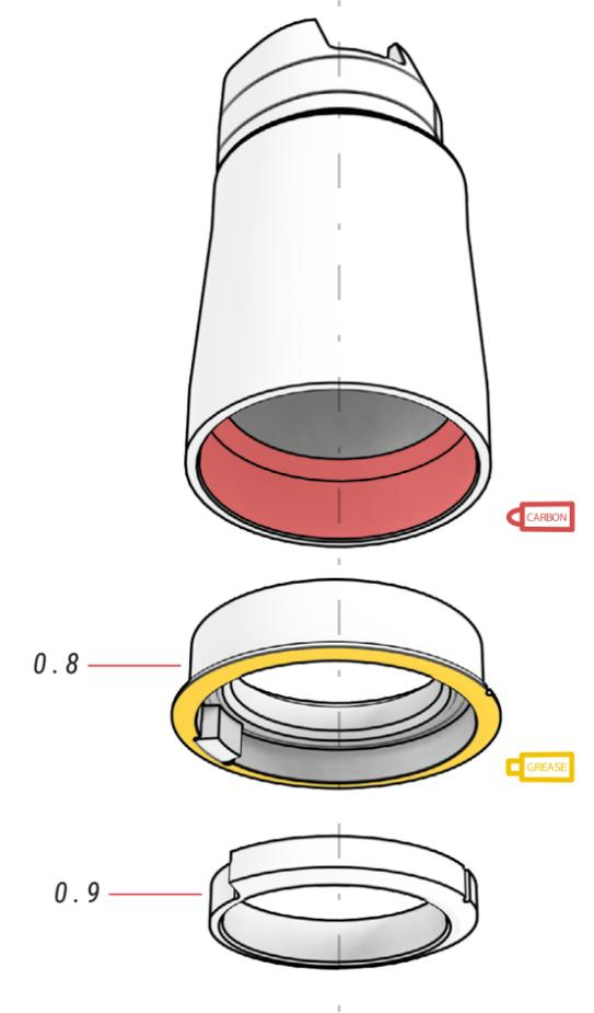
ⓘ Das Teil 0.8 kann mit der zum Rahmen zeigenden Kerbe montiert werden, aber das Teil 0.9 muss immer im Verhältnis zur Position der ersten montiert werden, wie in den Abbildungen dargestellt.
