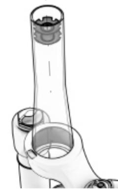
**⚠** Es ist ratsam, einen Abzieher zu verwenden, um sicherzustellen, dass der Zahnkranz perfekt ausgerichtet in den Gabelschaft eingesetzt wird.
