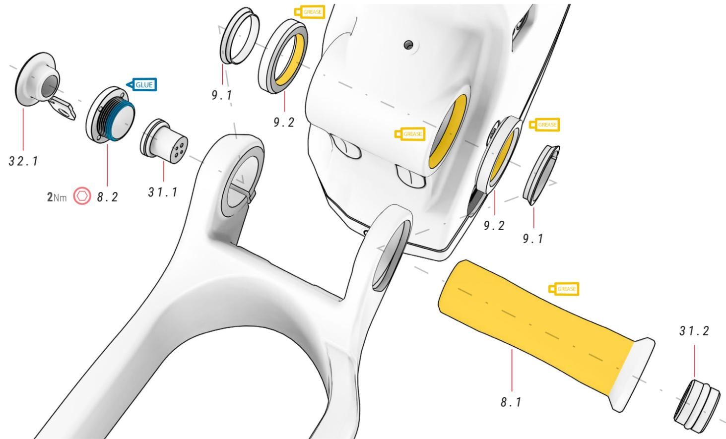
ⓘ La pieza 8.2 no debería apretarse más de 2Nm ya que su función es evitar holguras. El tornillo 10.2 fijará completamente la pieza 8.2 y el resto del conjunto del basculante.
