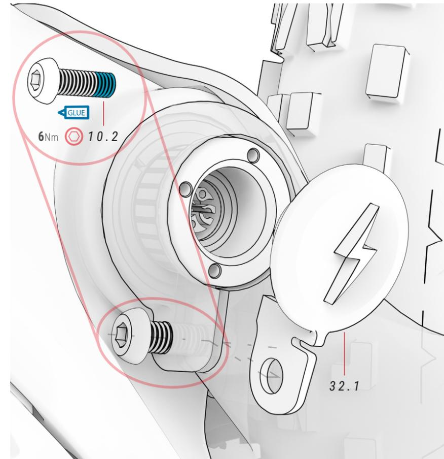
⚠ Para montar o desmontar la pieza 8.2, afloja siempre el tornillo 10.2. La pieza 8.2 ha sido diseñada para enroscarla y desenroscarla mediante la herramienta "Pin Spanner" o parecida. Diámetro de agujeros de 2.4mm.
