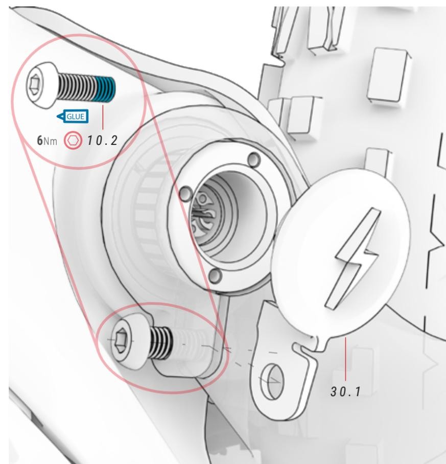
⚠ Per montare o smontare il componente 8.2, svitare sempre la vite 10.2. Il componente 8.2 è stato progettato per essere avvitato e svitato con l'utensile "Pin Spanner" o simile. Fori con diametro di 2,4 mm.
