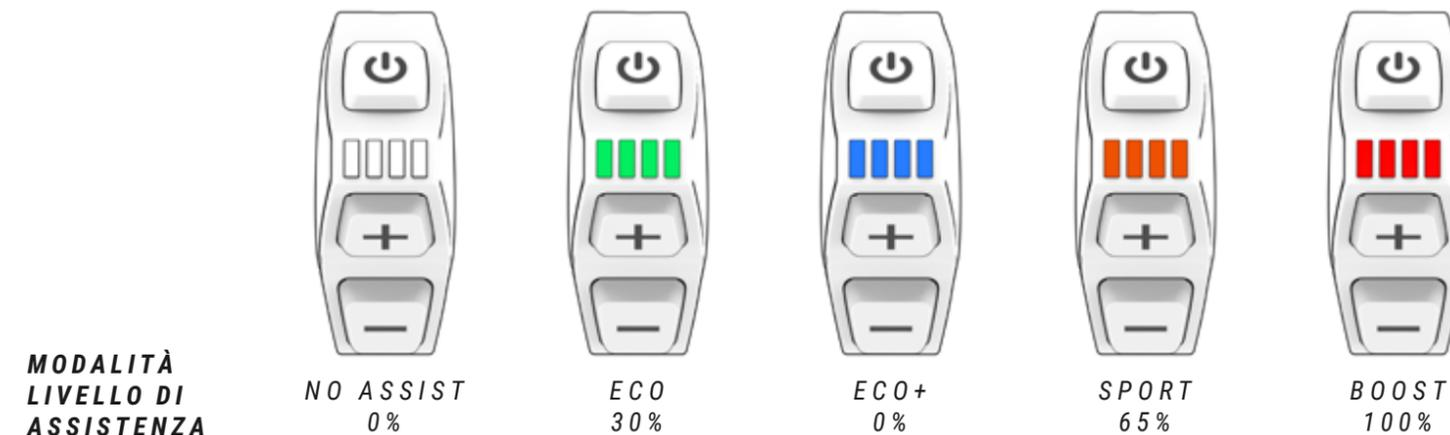
Per aumentare la vita utile della batteria e impedire uno scaricamento completo che potrebbe danneggiarla, le modalità di pedalata assistita possono essere limitate in funzione del livello di carica della batteria:
