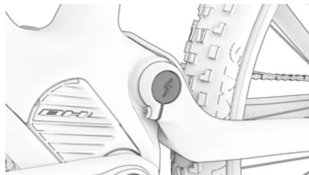
7. LA BATTERIA XPRO SI CARICHERÀ SE SI TROVA NEL PORTABORRACCIA, SE LA BICICLETTA È IN CARICA E SE I-REMOTE È ACCESO.
