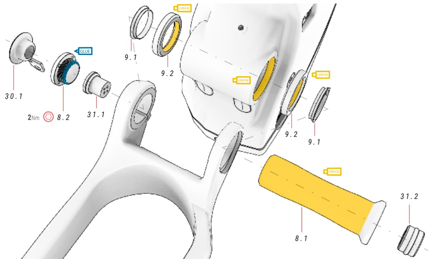
ⓘ Il componente 8.2 non dovrebbe essere serrato a oltre 2 Nm poiché ha la funzione di evitare allentamenti. La vite 10.2 fisserà completamente il componente 8.2 e il resto del gruppo del forcellone.
