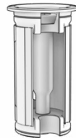
⚠ Le forcelle in carbonio non devono mai essere montate con ragnetto. Il ragnetto sottopone la forcella a uno sforzo per il quale non è stata progettata. Possono verificarsi rotture e causare incidenti.
