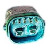
Quando i collegamenti elettrici entrano in contatto con punti umidi o vengono ostruiti a causa di una contaminazione esterna, si verifica una reazione chimica che causa un accumulo di cristalli di solfato di piombo nei collegamenti. In altre parole, il rame sui contatti si arrugginirà, causando
