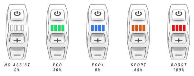
Per aumentare la durata della batteria ed evitare che si scarichi completamente e la danneggi, le modalità di assistenza sono limitate in base allo stato di carica della batteria:
