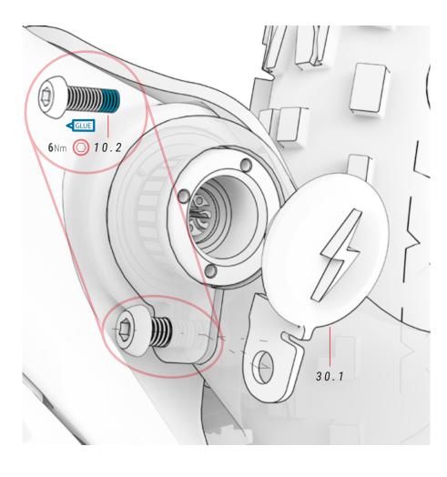
Allentare sempre il bullone 10.2 prima di montare o smontare la parte 8.2. La parte 8.2 è stata progettata in modo da poter essere filettata o rimossa con una "chiave a spillo" o uno strumento simile. Diametro del foro 2,4 mm.
