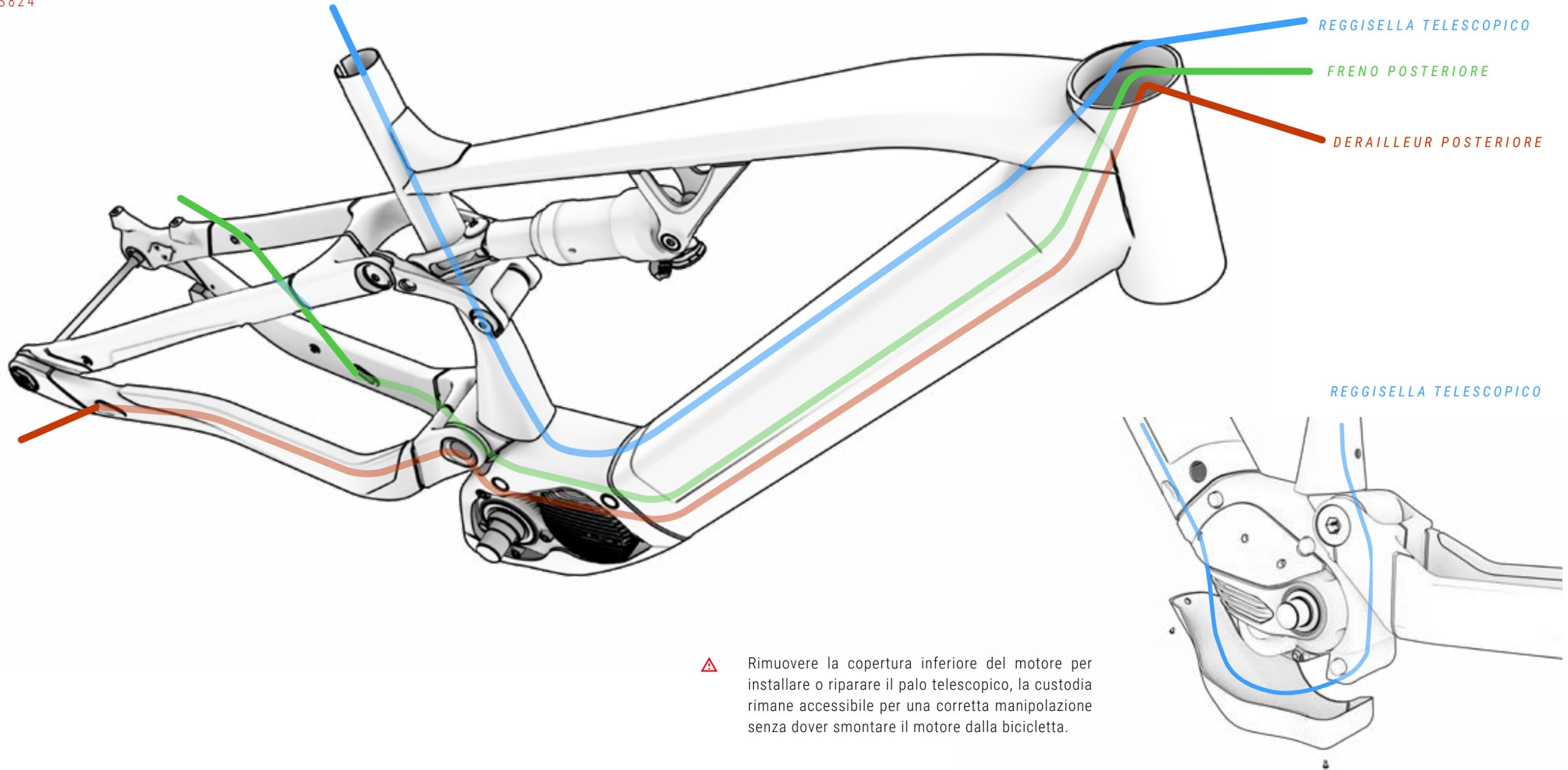
⚠ Rimuovere la copertura inferiore del motore per installare o riparare il palo telescopico, la custodia rimane accessibile per una corretta manipolazione senza dover smontare il motore dalla bicicletta.
