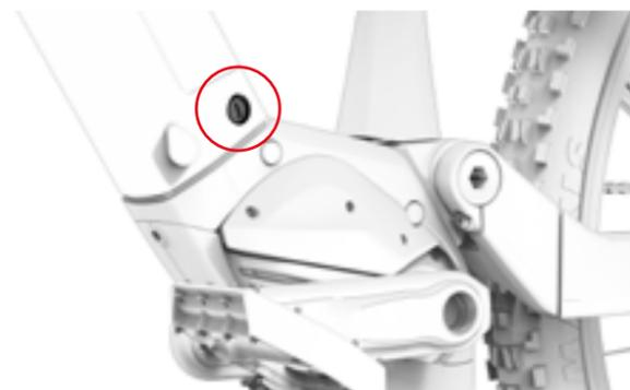
3. SOLLEVARE LA BATTERIA DAL BASSO PERMETTENDOLE DI RUOTARE SOPRA LA PARTE SUPERIORE.
