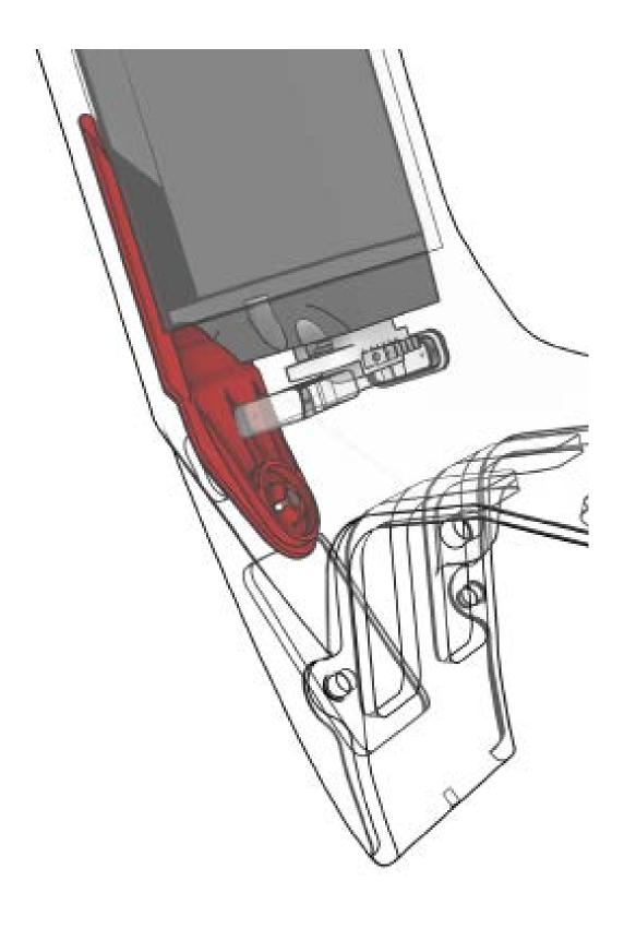
MONTAGGIO: RIMUOVERE LA PELLICOLA PLASTICA CHE PROTEGGE LA COLLA SUL PEZZO. SUCCESSIVAMENTE, INSERISCILO NEL TUBO DIAGONALE DELLA BICI E MONTALO PREMENDOLO CONTRO L'ALLOGGIAMENTO DELLA VITE (SEGNATA IN ROSSO) CHE FISSA LA COPERTURA DEL MOTORE. INFINE, PREMI LA PARTE CONTRO IL TELAIO IN MODO CHE LA COLLA LA FISSI COMPLETAMENTE.
