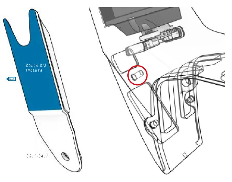
① Controllare le dimensioni del telaio per adattarle alla guida della batteria compatibile. Assemblare la stessa dimensione del telaio.
