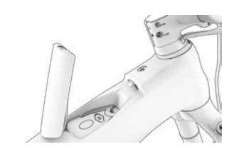
3. SOLLEVARE LA MANIGLIA DELLA BATTERIA E TIRARE VERSO L'ALTO PER CARICARLA ALL'ESTERNO DEL TELAIO. LASCIATELO SUL POSTO SE DESIDERI CARICARLO ALL'INTERNO DELLA STRUTTURA.
