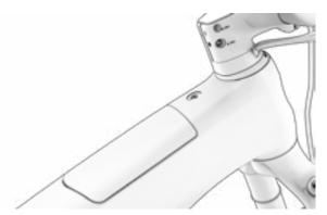
5. APRIRE IL COPERCHIO DELLA BATTERIA PER COLLEGARE PRIMA IL CARICABATTERIA E POI COLLEGARLO ALLA PRESA DI CORRENTE.
