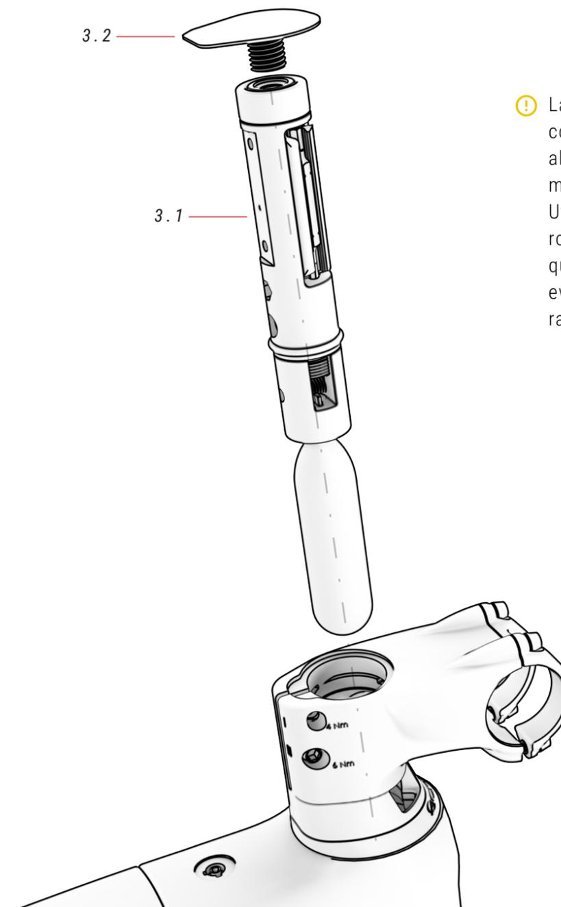
⚠ La serie sterzo deve essere completamente vuota all'interno prima di poter montare l'attrezzo FIT. Utilizzare il sistema di rondelle FIT progettato per questo scopo e rimuovere eventuali ostacoli come il ragnetto sul tubo sterzo.
