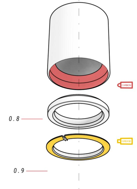
⚠ Il componente 0.8 si può montare con la tacca rivolta al telaio, ma il componente 0.9 deve essere sempre montato in base alla posizione del primo, come mostrato nelle figure.
