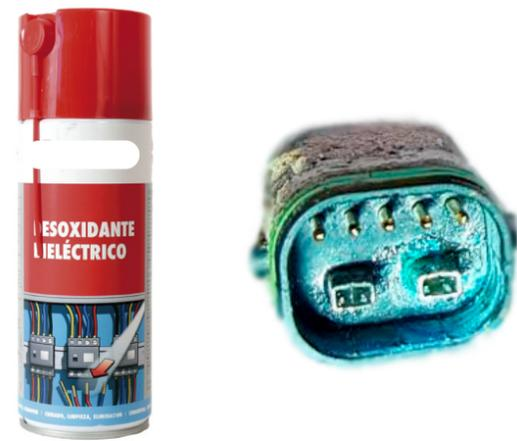
⚠ Quando un collegamento elettrico entra in contatto con umidità o viene ostruito a causa di una contaminazione esterna, si verifica una reazione chimica che determina la solfatazione dei collegamenti. Ciò significa che il rame dei contatti si ossida, causando difetti di conducibilità.
