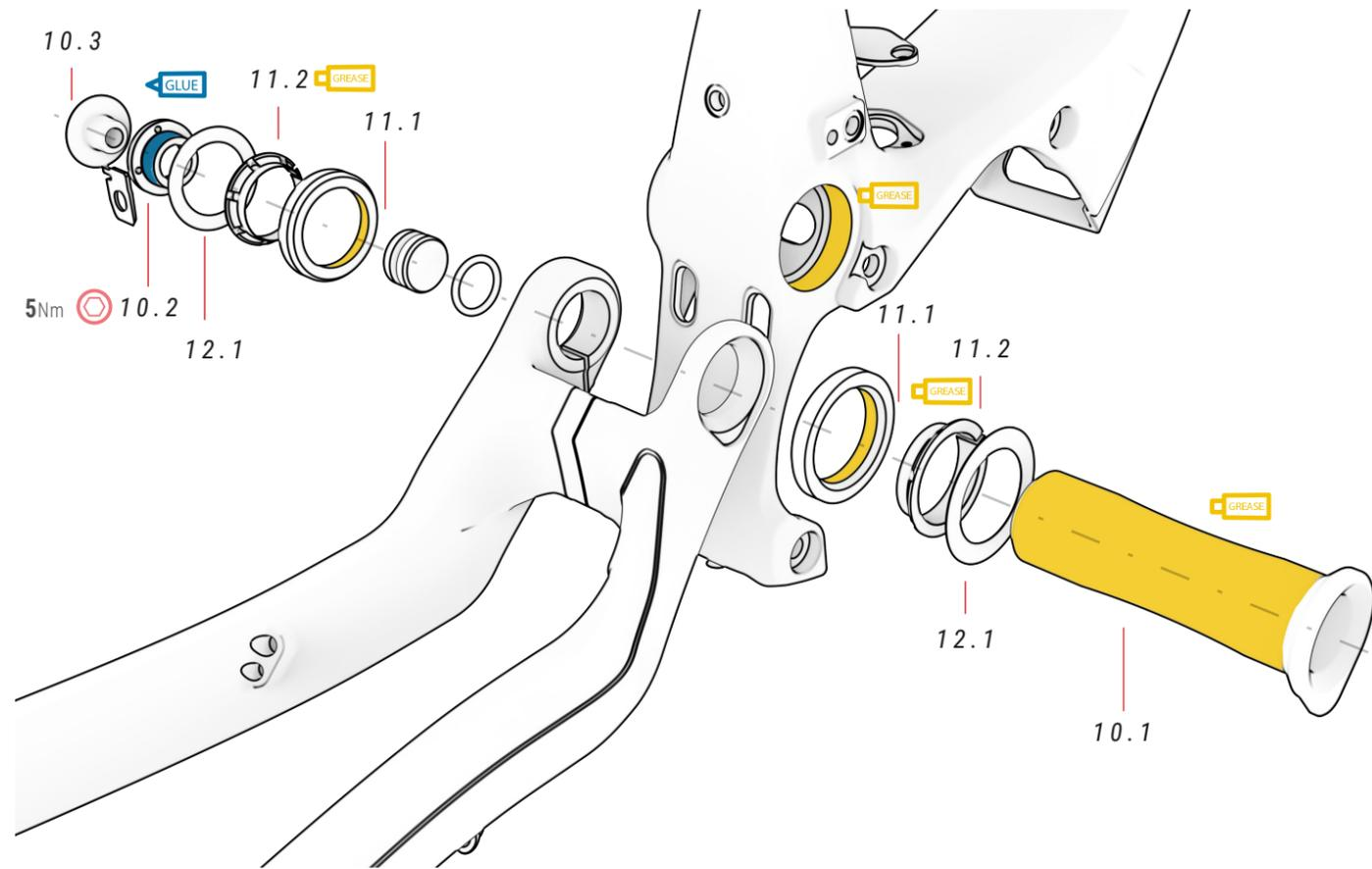
⚠ Il componente 10.2 non dovrebbe essere serrato a oltre 2 Nm poiché ha la funzione di evitare allentamenti. La vite 16.2 fisserà completamente il componente 10.2 e il resto del gruppo del forcellone.
