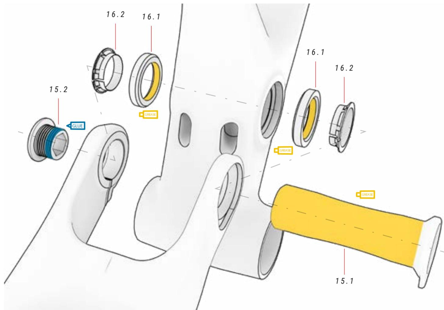
⚠ Il componente 15.2 non dovrebbe essere serrato a oltre 4 Nm poiché ha la funzione di evitare allentamenti. Il componente 18.1/17.1 fisserà completamente il componente 15.2.
