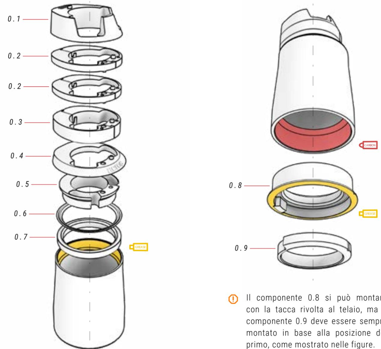
⚠ Il componente 0.8 si può montare con la tacca rivolta al telaio, ma il componente 0.9 deve essere sempre montato in base alla posizione del primo, come mostrato nelle figure.
