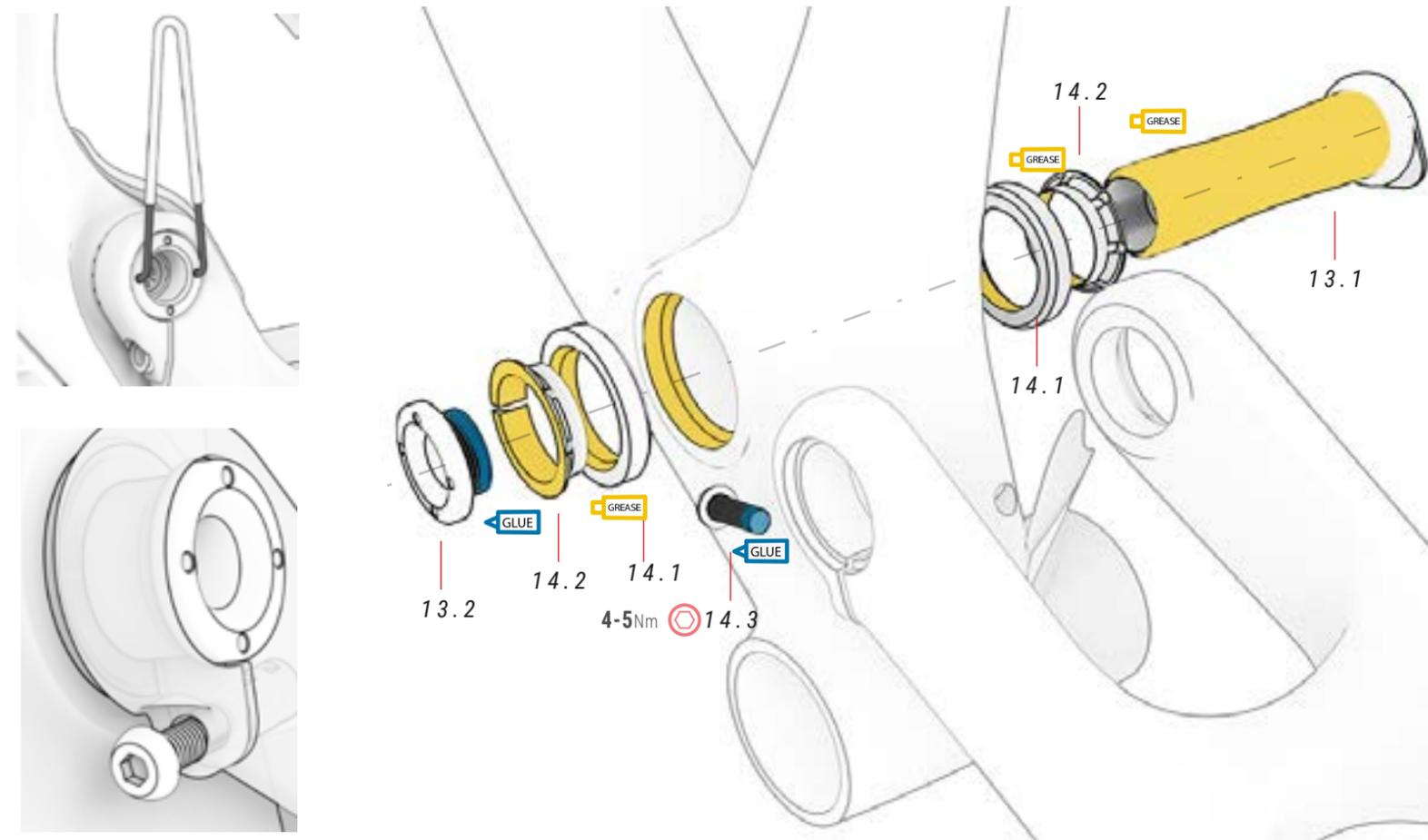
⚠ Allentare sempre la vite 13.3 prima di montare o smontare la parte 13.2. La parte 13.2 è progettata per essere filettata con una chiave inglese. Diametro 2,4 mm
