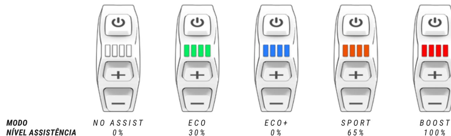
Para aumentar a vida da bateria e evitar que a mesma se descarregue totalmente, o que poderia danificá-la, os modos de assistência estão limitados em função da carga da bateria:
