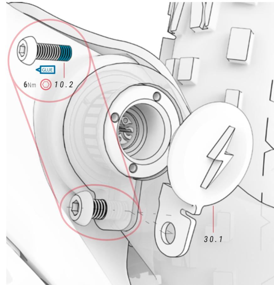
⚠ Para montar ou desmontar a peça 8.2, desaperte sempre o parafuso 10.2. A peça 8.2 foi concebida para apertar e desapertar com a ferramenta "Pin Spanner" ou similar. Diâmetro dos orifícios: 2.4 mm.
