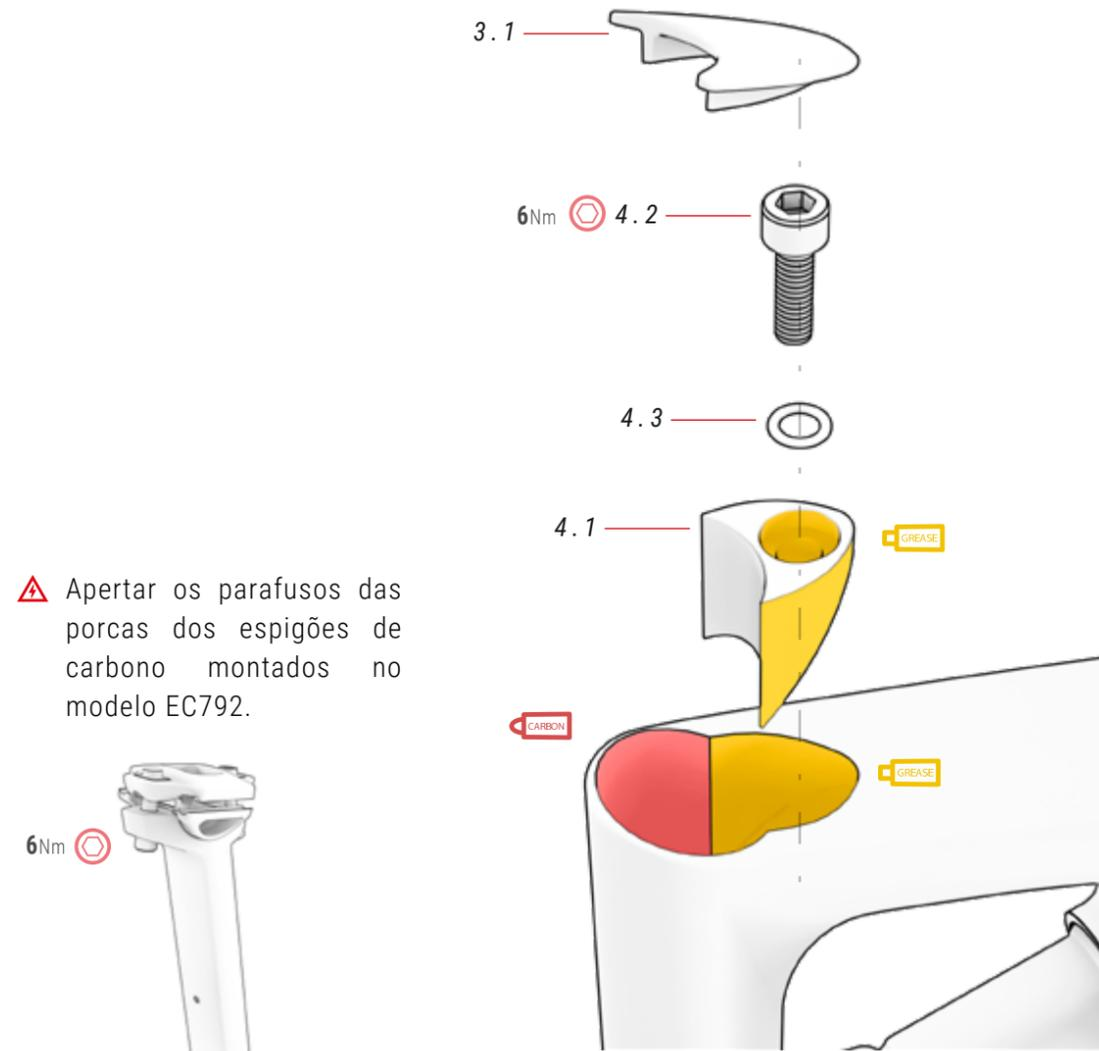
⚠ Apertar os parafusos das porcas dos espigões de carbono montados no modelo EC792.
