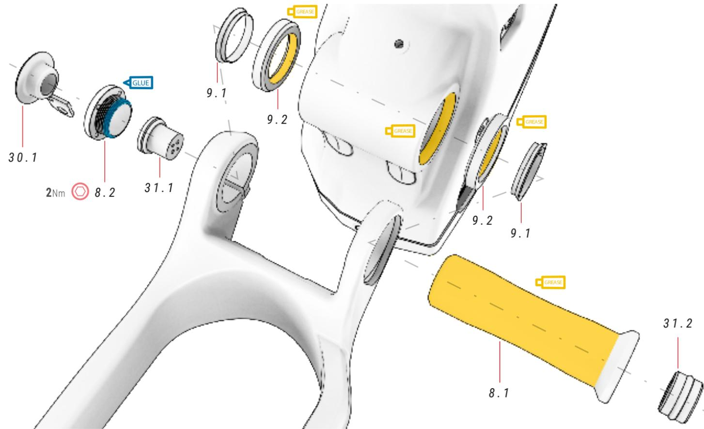
ⓘ A peça 8.2 não deve apertar-se mais de 2 Nm, pois a sua função é evitar folgas. O parafuso 10.2 fixa completamente a peça 8.2 e o resto do conjunto do braço oscilante.
