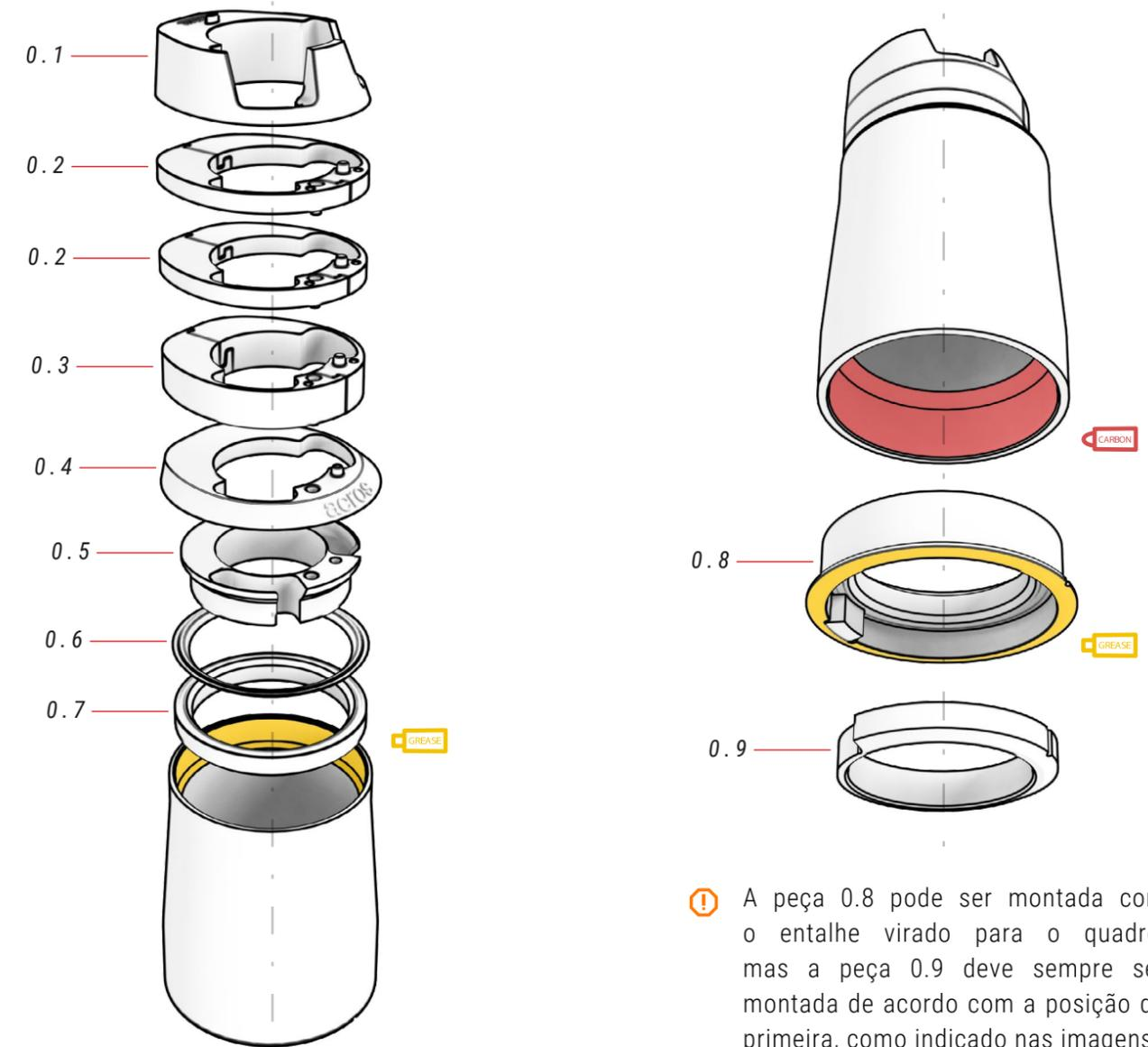
⚠ A peça 0.8 pode ser montada com o entalhe virado para o quadro, mas a peça 0.9 deve sempre ser montada de acordo com a posição da primeira, como indicado nas imagens.
