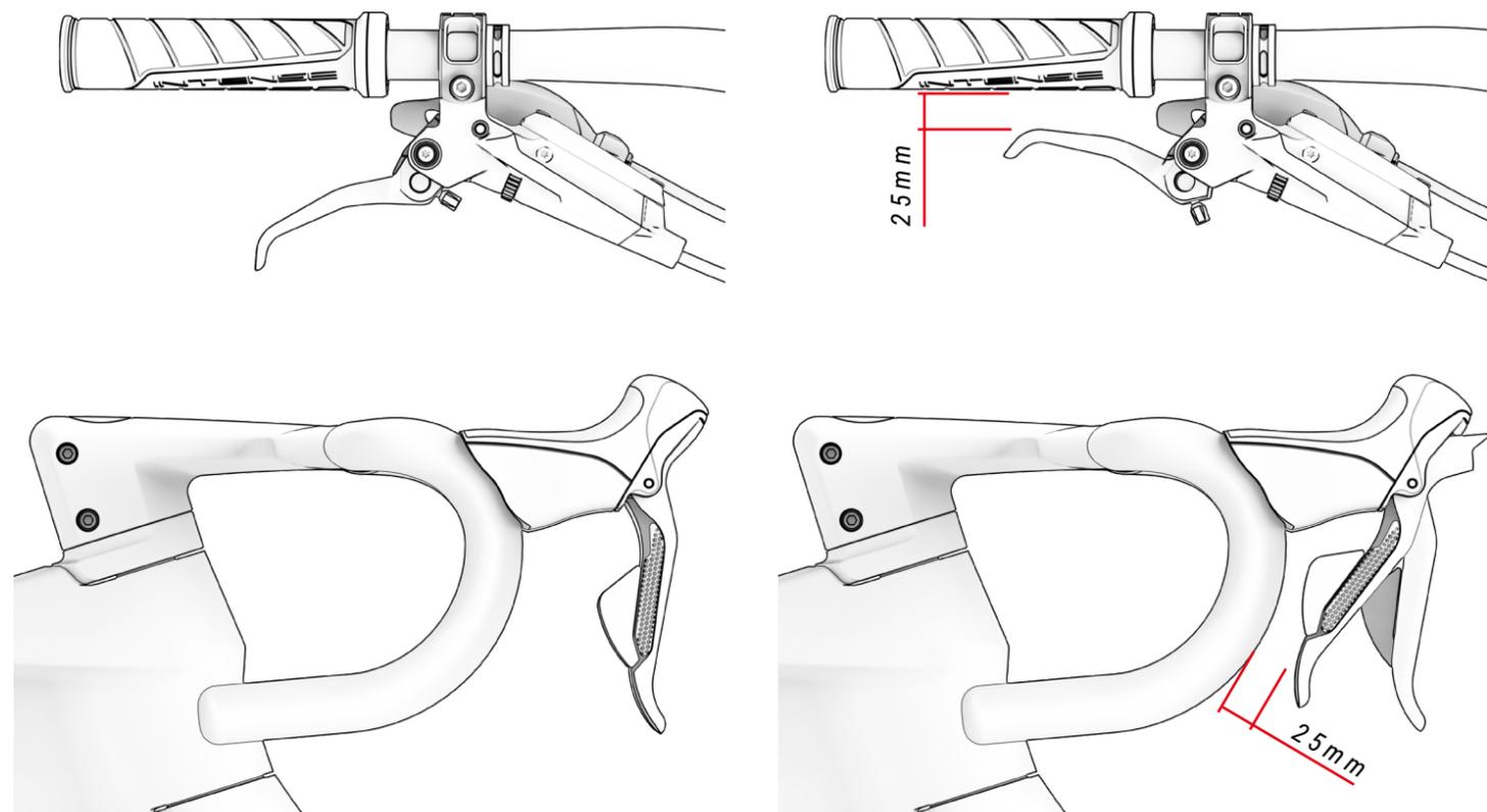
Por outro lado, antes de cada utilização, é necessário inspecionar o estado dos cabos ou do sistema hidráulico, dependendo do tipo de travão. No caso dos travões acionados por cabo, devem manter-se bem fixados de acordo com os binários de aperto definidos pelos fabricantes dos componentes. Além disso, tem de se inspecionar visualmente se existe algum defeito.
