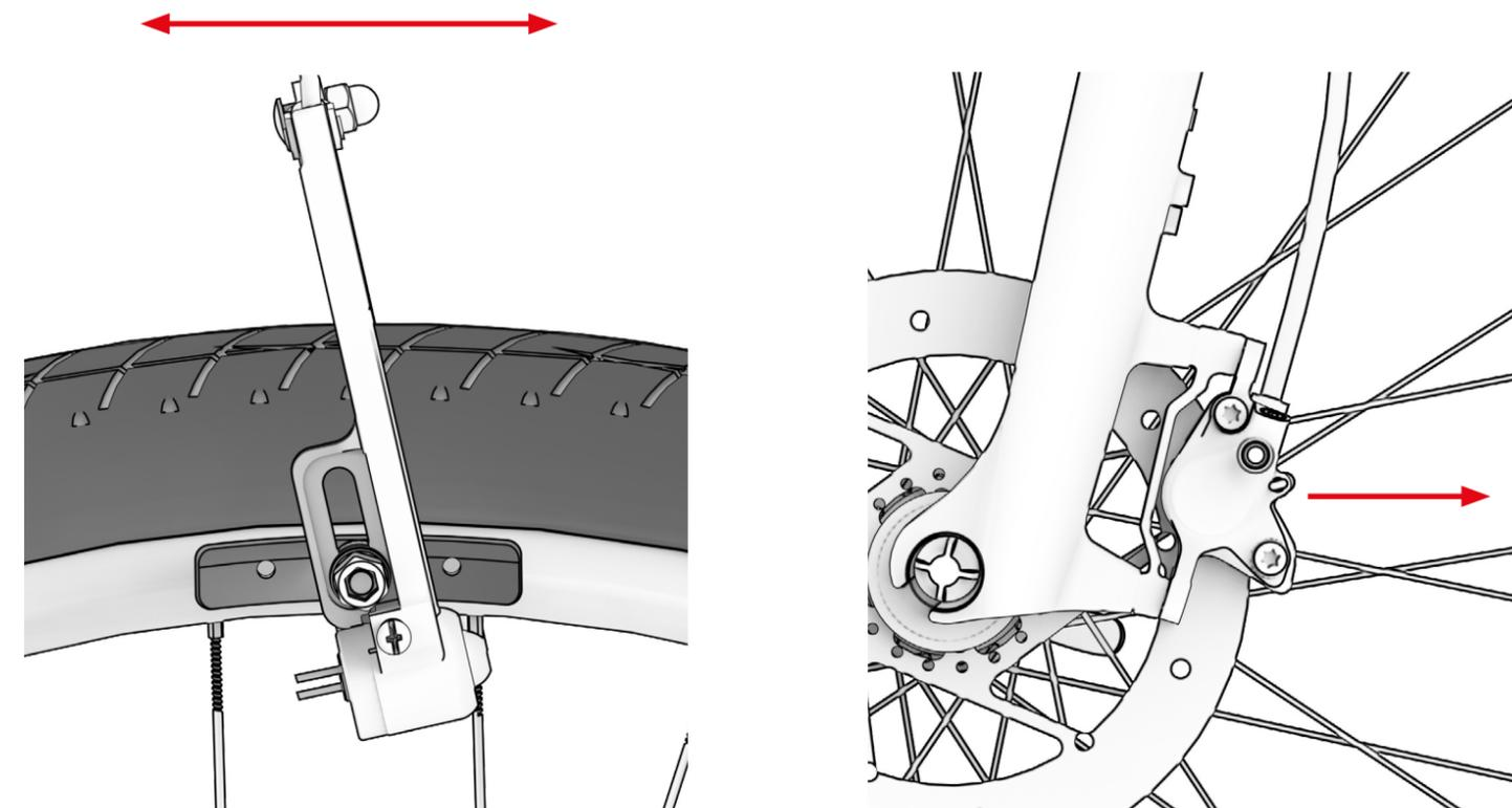
Nos travões com calço, também é necessário estar atento à posição. Como se vê nas imagens abaixo, os calços devem manter-se a uma distância entre 1 e 2 mm do pneu. Nunca devem estar em contacto com o pneu. Além disso, os calços devem estar montados com uma ligeira inclinação no sentido de rotação da roda. Para otimizar a travagem e reduzir os ruídos.
