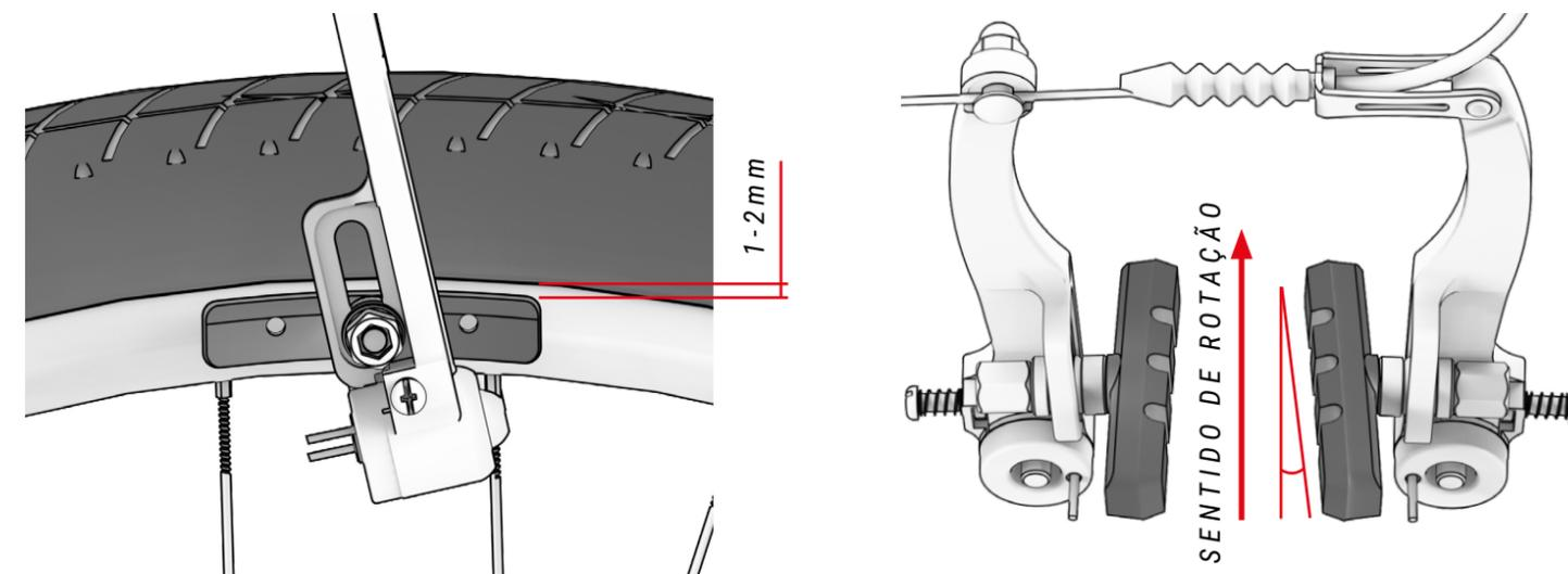
Tanto os calços como as pastilhas dos travões de disco são peças de desgaste que devem ser substituídas de acordo com as especificações do fabricante. Da mesma forma que as pastilhas, os discos do travão também estão sujeitos a desgaste e, antes de cada viagem, é necessário verificar se estão gastos, dobrados ou com alguma anomalia.
