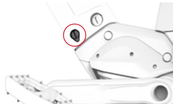
3. CONECTAR EL CARGADOR PRIMERO AL PUERTO DE CARGA Y DESPUÉS A LA TOMA DE CORRIENTE.
