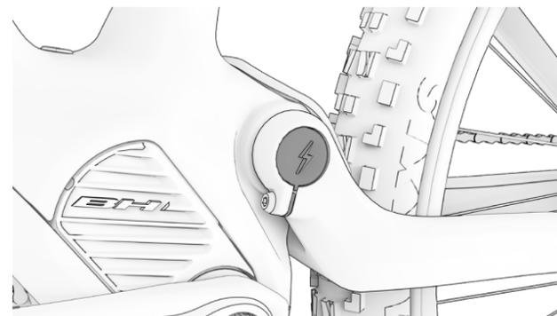
7. LA BATERÍA XPRO DD SE CARGARÁ SI SE ENCUENTRA EN EL PORTABIDÓN Y LA BICICLETA ESTÁ CARGANDO Y CON EL BH IREMOTE ENCENDIDO.
