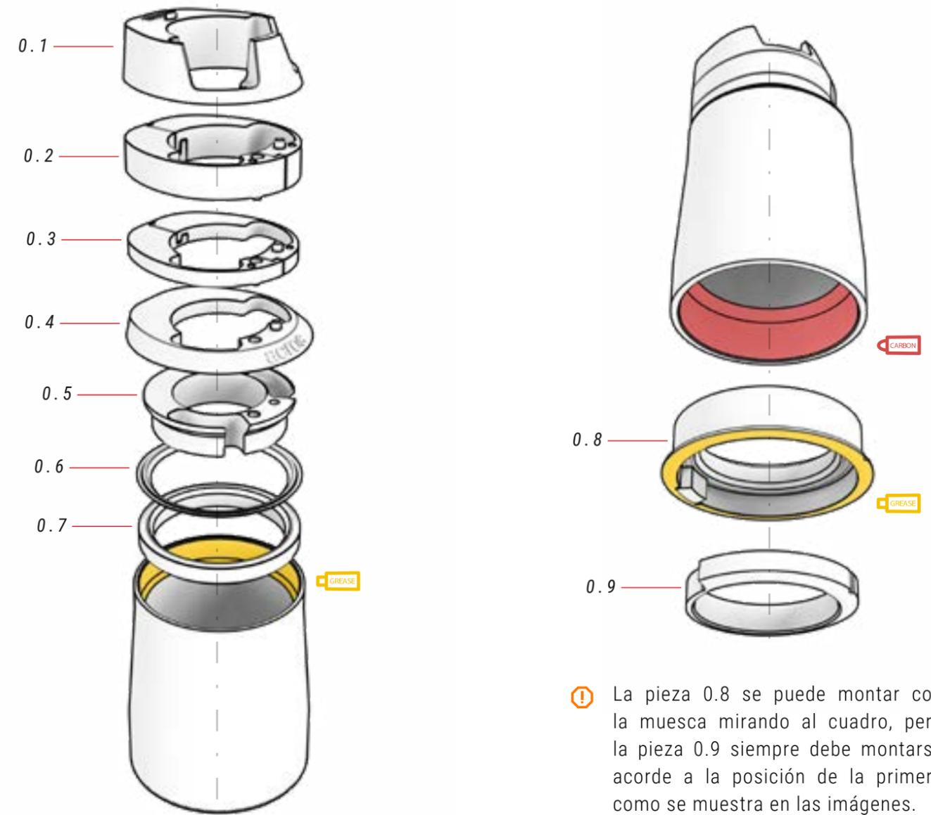
⚠ La pieza 0.8 se puede montar con la muesca mirando al cuadro, pero la pieza 0.9 siempre debe montarse acorde a la posición de la primera como se muestra en las imágenes.
