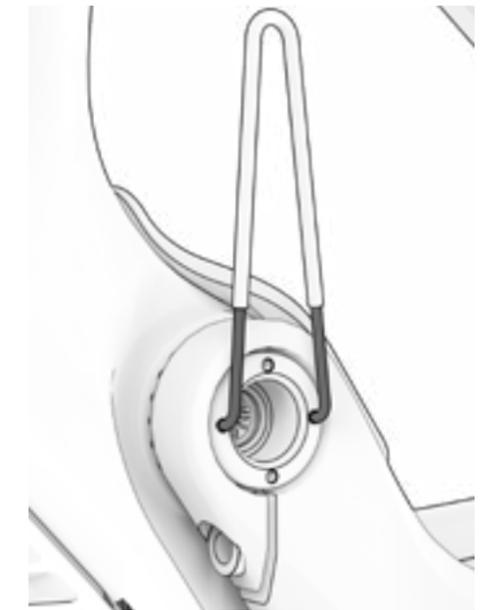
⚠ La pieza 11.2 no debería apretarse más de 2Nm ya que su función es evitar holguras. El tornillo 10.2 fijará completamente la pieza 11.2 y el resto del conjunto del basculante.
