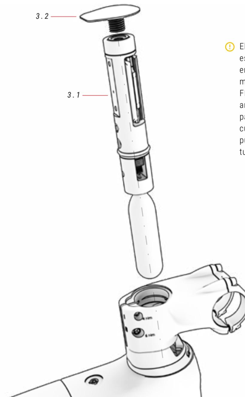
⚠ El juego de dirección debe estar completamente vacío en su interior para poder montar la herramienta FIT. Utiliza el sistema de arandelas FIT diseñado para este fin y retira cualquier obstáculo como pudiera ser la araña en el tubo de dirección.
