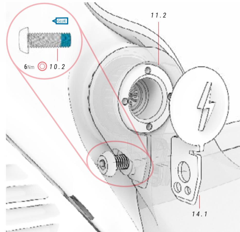
⚠ Para montar o desmontar la pieza 11.2, afloja siempre el tornillo 10.2. La pieza 11.2 ha sido diseñada para enroscarla y desenroscarla mediante la herramienta "Pin Spanner" o parecida. Diámetro de agujeros de 2.4mm.
