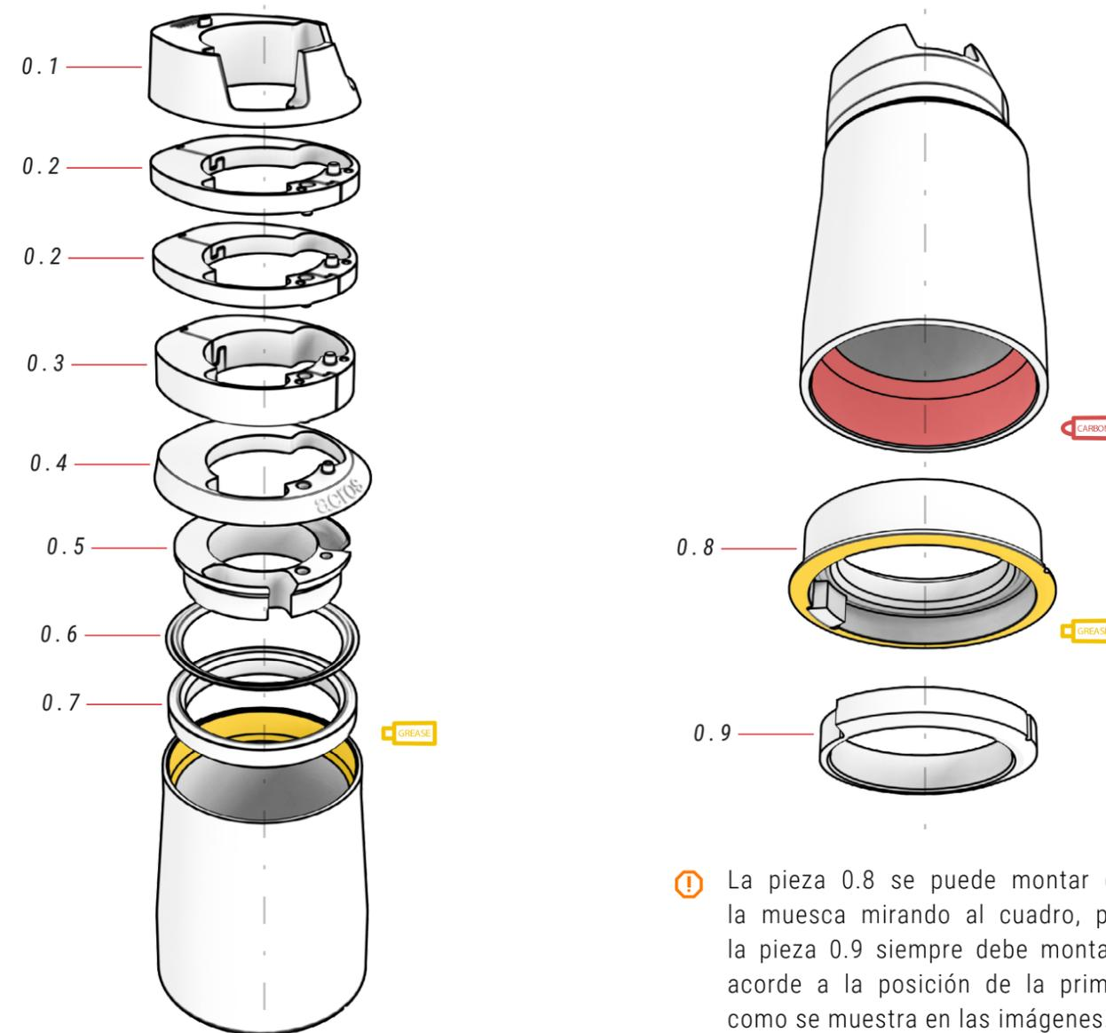
⚠ La pieza 0.8 se puede montar con la muesca mirando al cuadro, pero la pieza 0.9 siempre debe montarse acorde a la posición de la primera como se muestra en las imágenes.
