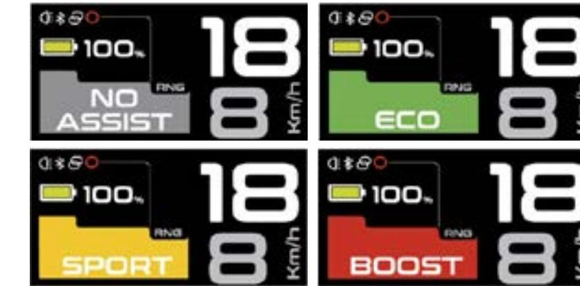
Con objeto de incrementar la vida de la batería y prevenir a la misma de una descarga completa que pudiera dañarla, los modos de asistencia están limitados en función de la carga de la batería:
