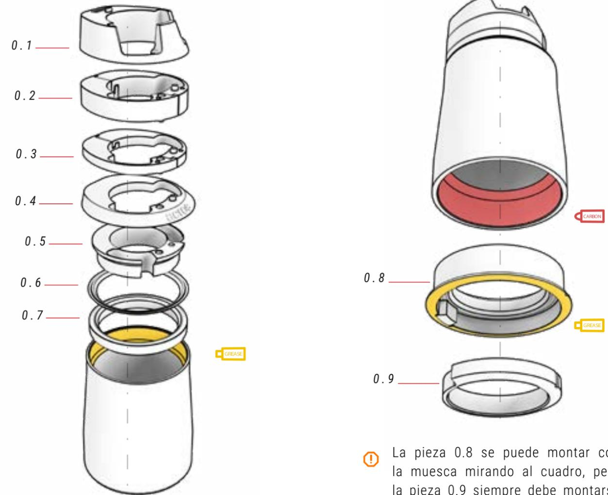
⚠ La pieza 0.8 se puede montar con la muesca mirando al cuadro, pero la pieza 0.9 siempre debe montarse acorde a la posición de la primera como se muestra en las imágenes.
