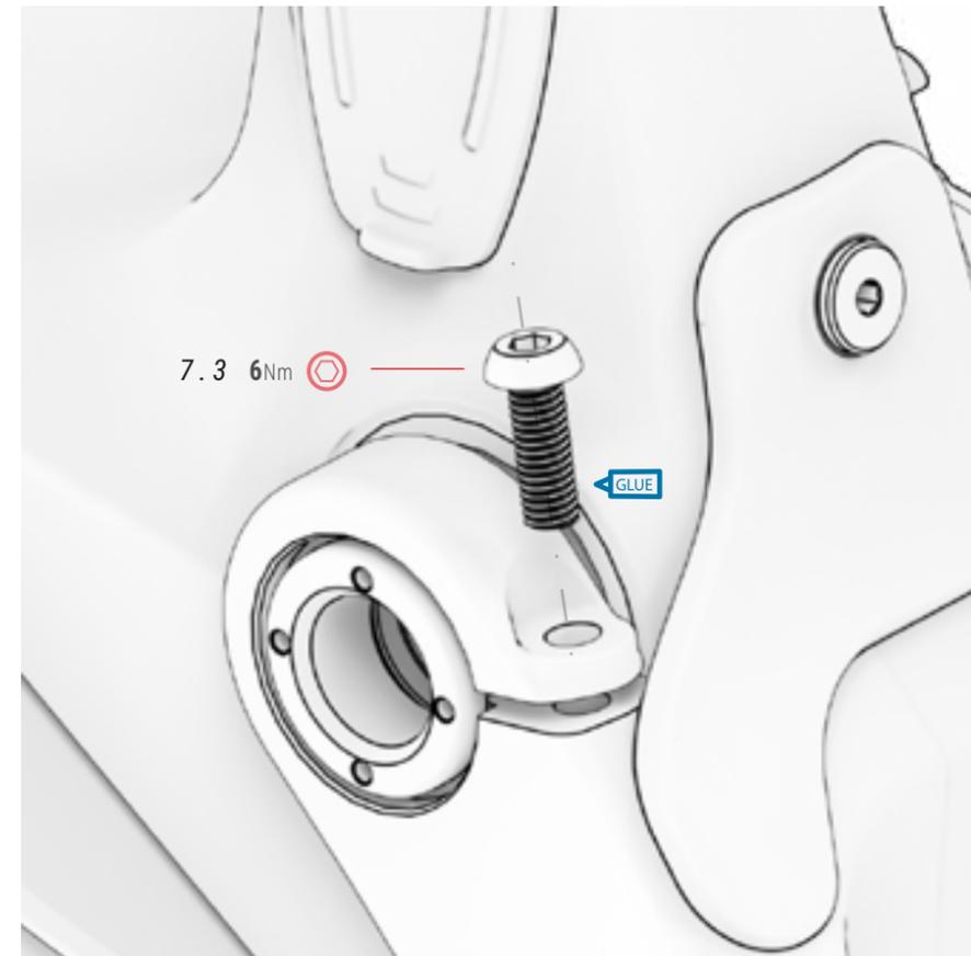
⚠ Para montar o desmontar la pieza 7.2, afloja siempre el tornillo 7.3. La pieza 7.2 ha sido diseñada para enroscarla y desenroscarla mediante la herramienta "Pin Spanner" o similar. Diámetro de agujeros de 2.4mm.
