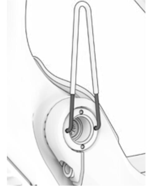
⚠ La pieza 10.2 no debería apretarse más de 5 Nm ya que su función es evitar holguras. La pieza 16.2 fijará completamente la pieza 10.2.
