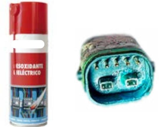
⚠ Cuando una conexión eléctrica entra en contacto con humedad o está tupida debido a una contaminación externa, se produce una reacción química por la cual las conexiones se sulfatan. Es decir, el cobre de los contactos se oxida, provocando fallos de conductividad.
