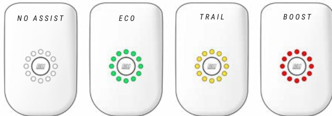
Con objeto de incrementar la vida de la batería y prevenir a la misma de una descarga completa que pudiera dañarla, los modos de asistencia están limitados en función de la carga de la batería:
