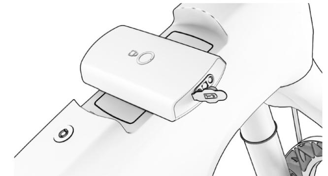
**5. CONECTAR EL CARGADOR PRIMERO A LA BATERÍA Y DESPUÉS A LA TOMA DE CORRIENTE.**
