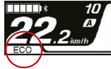
Con objeto de incrementar la vida de la batería y prevenir a la misma de una descarga completa que pudiera dañarla, los modos de asistencia están limitados en función de la carga de la batería:
