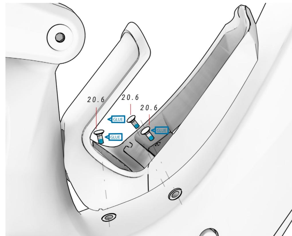
⚠ Una longitud de los tornillos por encima de la debida puede ocasionar daños en la batería no cubiertos por la garantía. Nunca fuerces los tornillos.
