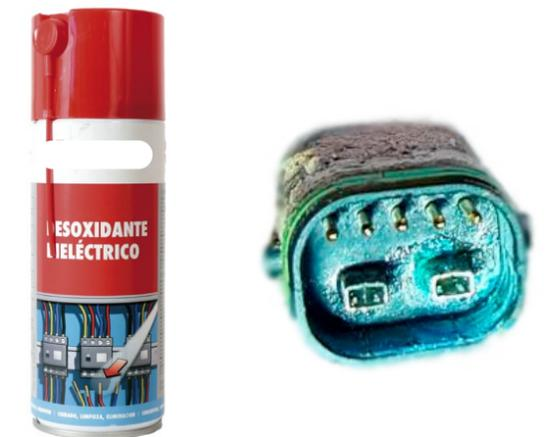
⚠ Cuando una conexión eléctrica entra en contacto con humedad o está tupida debido a una contaminación externa, se produce una reacción química por la cual las conexiones se sulfatan. Es decir, el cobre de los contactos se oxida, provocando fallos de conductividad.
