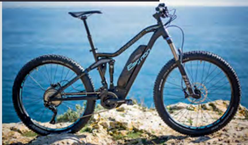
La gama Rebel, a diferencia de la Atom, equipa las potentes motorizaciones Yamaha con su tecnologías PW y PW-X. Incorporan un motor central compacto e integrado y una batería de extracción lateral que está colocada en el triángulo delantero. Digamos que el motor Yamaha es la "antítesis" al motor Brose.
