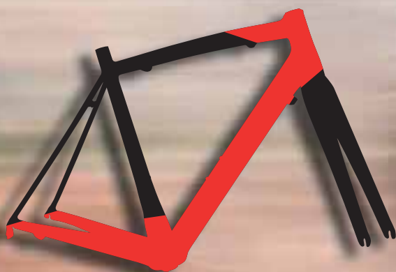
Disposición del carbono en el cuadro para obtener máxima rigidez y firmeza
