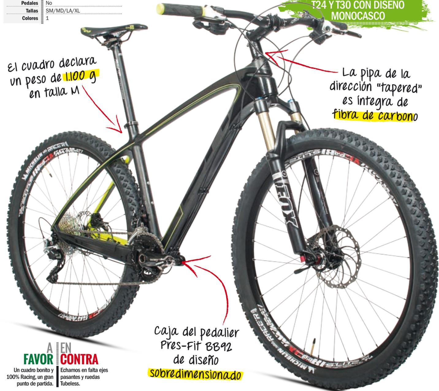
Caja del pedalier Pres-Fit BB92 de diseño sobredimensionado
