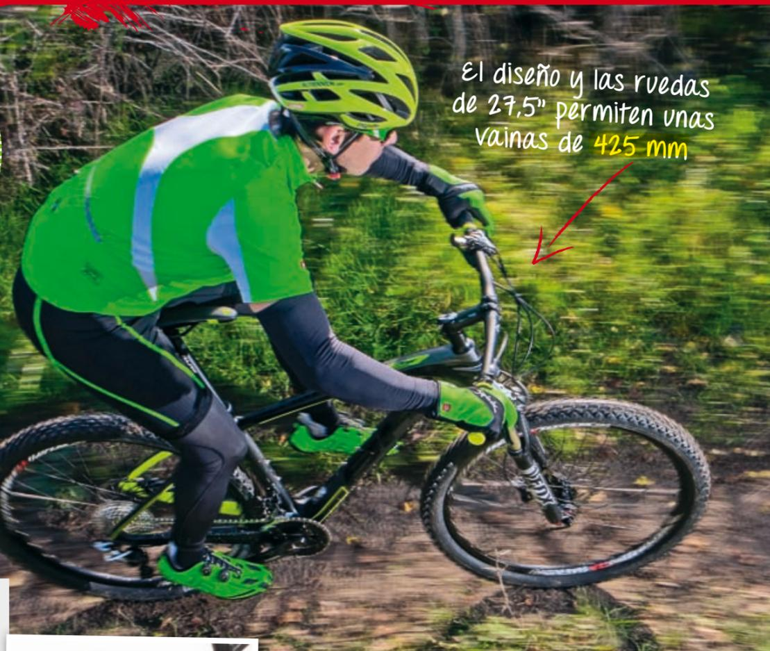
El diseño y las ruedas de 27,5" permiten unas vainas de 425 mm
