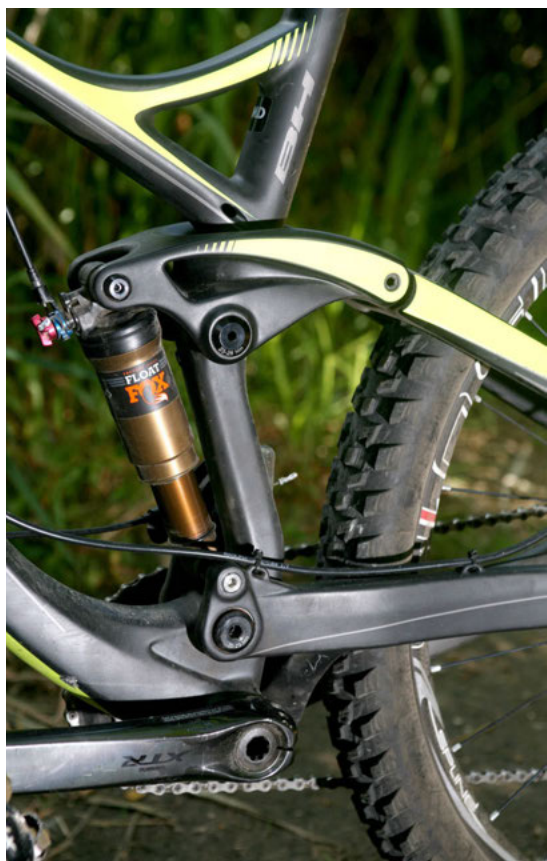
Biellette carbone, nouvel amortisseur Fox monté sur les bases, finition de tout premier ordre, ce BH en jette !
