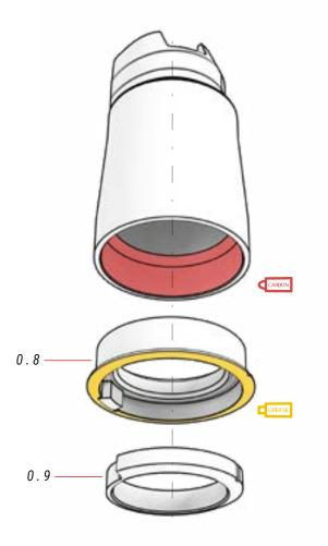
Das Teil 0.8 kann mit der zum Rahmen zeigenden Kerbe montiert werden, aber das Teil 0.9 muss immer im Verhältnis zur Position der ersten montiert werden, wie in den Abbildungen dargestellt.
