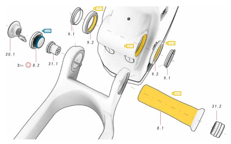
① Das Teil 8.2 darf nicht mit mehr als 2 Nm angezogen werden, da seine Funktion darin liegt, Spiel zu vermeiden. Die Schraube 10.2 befestigt vollständig das Teil 8.2 und den Rest der Schwingenbaugruppe.
