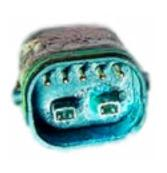
Wenn ein elektrischer Anschluss feucht wird oder durch eine äußere Verschmutzung verdichtet ist, kommt es zu einer chemischen Reaktion, durch die die Verbindungen sulfatisiert werden. Das heißt, das Kupfer der Kontakte oxidiert und es kommt zu Störungen bei der Leitfähigkeit.
