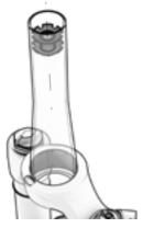
Es empfiehlt sich, einen Stumpfer zu verwenden, um sicherzustellen, dass der Spider perfekt ausgerichtet in das Steuerrohr eingesetzt wird.
