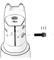
Der Vorbau muss perfekt zum Rad ausgerichtet sein. 2. SETZEN SIE DIE GABEL IN DEN LENKKOPF EIN UND ZIEHEN SIE DIE OBERE SCHRAUBE FEST (5 NM), UM JEGLICHES SPIEL ZU BESEITIGEN.
