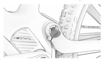
3. SCHLIESSEN SIE IMMER ZUERST DAS LADEGERÄT AN DIE BATTERIE AN UND DANACH AN DEN NETZSTROM.
