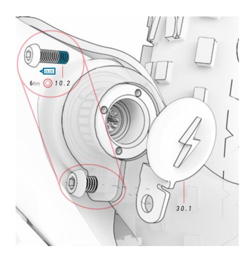
Für die Montage oder Demontage des Teils 8.2 muss immer die Schraube 10.2 gelöst werden. Das Teil 8.2 ist so konzipiert, dass es mit dem "Pin Spanner"-Werkzeug oder ähnlichem ein- und ausgeschraubt werden kann. Durchmesser der Bohrungen 2,4 mm.
