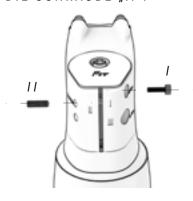
⚠ Der Zweck des Festziehens der Schrauben besteht darin, die Unterlegscheiben am Verschieben zu hindern. Wenden Sie daher nicht zu viel Drehmoment an.
